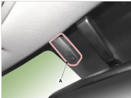
3. 分离除湿传感器连接器 (B)，拆卸自动除湿传感器 (A)。
